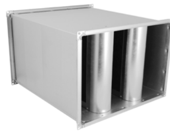
Tłumik SLC z kulisami absorpcyjnymi – ramka stalowa + wełna mineralna z welonem.
